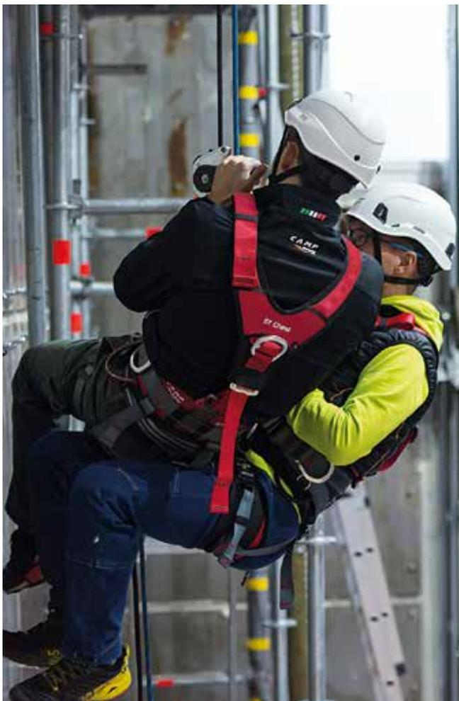
Prove di evacuazione di emergenza con due persone con un prototipo del discensore Giant.
