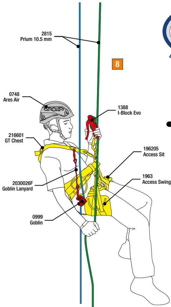
**Fig.8** - L'accesso dall'alto è la soluzione più semplice per raggiungere la zona di lavoro evitando così la risalita dal basso, che comporta un notevole dispendio di energie. In questo caso può essere sufficiente utilizzare solamente un discensore che permetta la sola discesa sulla corda di lavoro, sempre abbinato all'anticaduta sulla corda di sicurezza.
