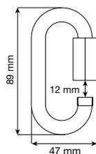
Maillon rapide ovale pour les connexions fixes de haute résistance. En acier inoxydable, pour une installation extérieure, ou dans des environnements corrosifs.
