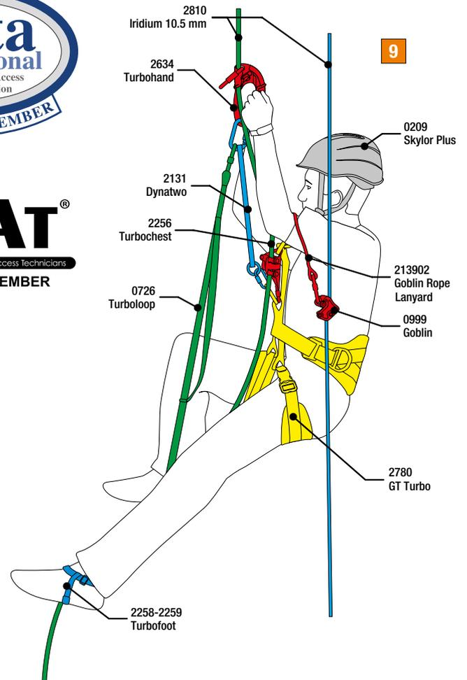
**Fig.9** - Nei casi in cui si renda necessario accedere dal basso con corde già pre-installate, oppure quando ci sia la necessità di risalire lunghi tratti di corda, la risalita si effettua con un bloccante ventrale installato sull'imbracatura ed una maniglia di risalita che, abbinati ad una staffa, permettono una progressione veloce e poco dispendiosa.
