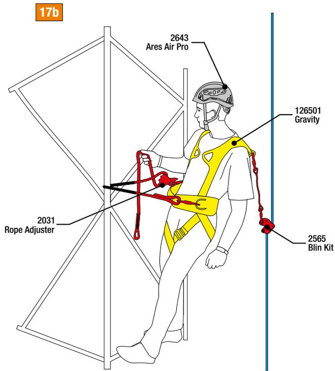
**Abb.17a** - Nach dem Aufstieg des ersten Arbeiters kann ein oder mehrere Seile an der Spitze der Struktur fixiert werden, an der sich die Arbeiter durch geeignete Absturzsicherungen für Seile befestigen können, welche die senkrechte Fortbewegung gestatten.
