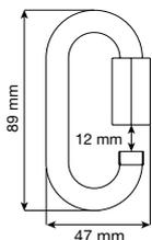
Maillon rapide ovale pour les connexions fixes de haute résistance. En acier au carbone zingué. Disponible en deux versions : fabriqué avec du fil de 8 mm (verrouillage avec clé de 14 mm) ou avec du fil de 10 mm (verrouillage avec une clé de 17 mm).
