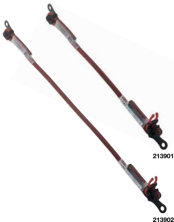
Goblin Rope Lanyard è uno specifico cordino da utilizzare con l'anticaduta Goblin in accesso su corda EN 12841/A in combinazione con una corda semi-statica di diametro da 10 a 11 mm. E' costruito con una corda dinamica da 11 mm ed è perfetto per gli specialisti dell'accesso su corda.
