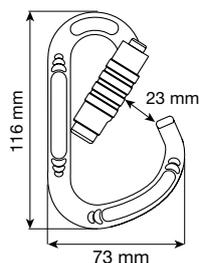
Moschettone in lega d'alluminio, caratterizzato da un'ampia apertura e dalla forma specifica per la costruzione di nodi.
