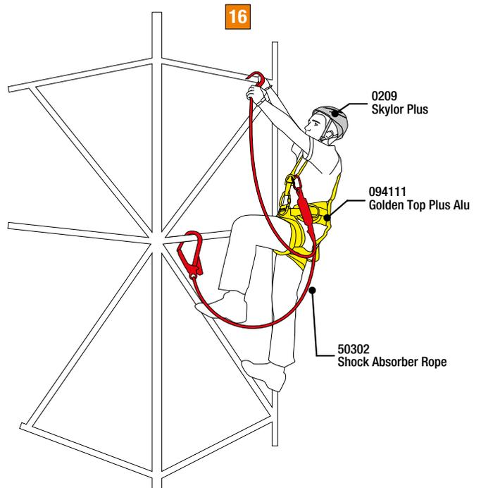
**Fig.16** - Per la progressione su strutture prive di dispositivi di ancoraggio, è possibile progredire ancorandosi direttamente alla struttura (previa verifica di resistenza) attraverso un cordino doppio con assorbitore di energia e connettori adeguati alla dimensione della struttura.
