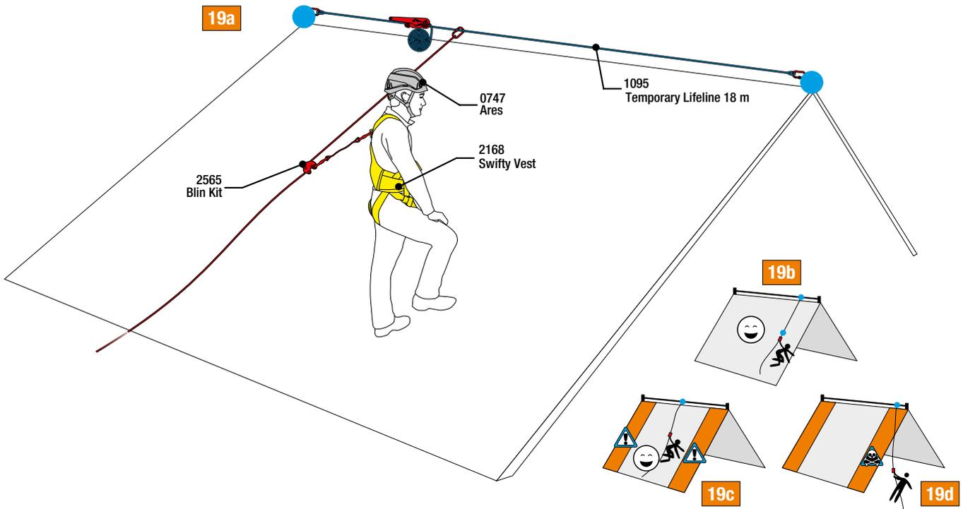
**Fig.19** - Su tetti e terrazze è possibile ancorarsi a linee di ancoraggio orizzontali (che possono essere già pre-installate oppure temporanee) oppure a punti di ancoraggio singoli. Per la movimentazione ed il lavoro è possibile utilizzare una corda a cui viene connesso un dispositivo anticaduta per corda: l'operatore può muoversi liberamente e il dispositivo interviene in caso di caduta (**fig.19a**).
