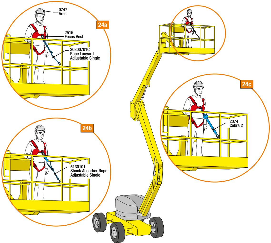
**Fig.24** - La soluzione più semplice per prevenire il rischio di proiezione all'esterno dell'operatore è l'utilizzo di un'imbracatura completa a cui sia fissato un cordino regolabile. Fissando quest'ultimo agli opportuni punti di ancoraggio presenti sulla piattaforma, e regolandone opportunamente la lunghezza, l'operatore rimarrà ancorato alla superficie della piattaforma anche in caso di pericolose oscillazioni verticali (**fig.24a**).
